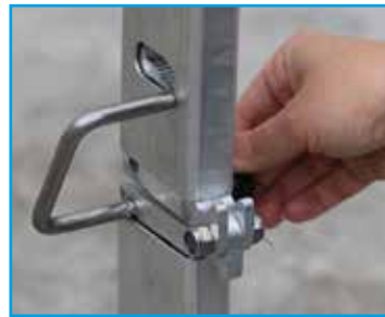
3. Relever la manette au niveau du logement oblong situé dans le montant.
