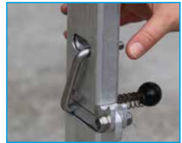
4. Enclencher la manette dans le logement en relâchant la poignée (le logement est muni de crans) de verrouillage, afin de verrouiller complètement le montant, puis pousser la manette côté extérieur jusqu'au dernier cran. Le système est alors entièrement verrouillé.
