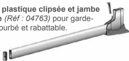
Fixation de l'embase au montant réalisée par un coin de blocage (Réf : 04773)
